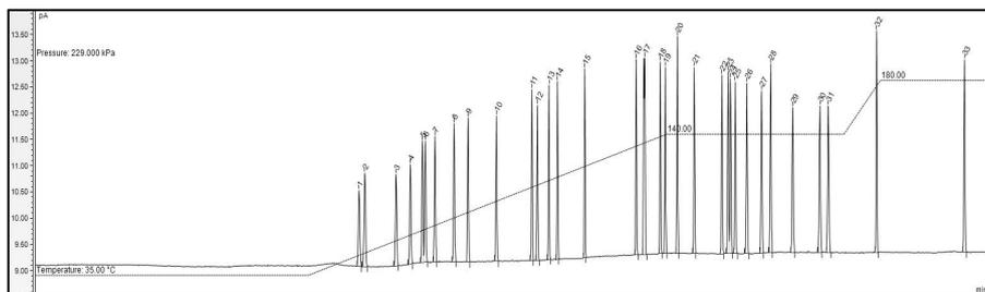
出峰顺序为：1：甲基环戊烷、2：2,4-二甲基戊烷、3：苯、4：环己烷、5：2-甲基己烷、6：2,3-二甲基戊烷、7：3-甲基己烷、8：2,2,4-三甲基戊烷、9：正庚烷、10：甲基环己烷、11：2,3,4-三甲基戊烷、12：甲苯、13：2-甲基庚烷、14：3-甲基庚烷、15：正辛烷、16：乙苯、17：间/对二甲苯、18：苯乙烯、19：邻二甲苯、20：壬烷、21：异丙苯、22：正丙基苯、23：间乙基甲苯、24：对乙基甲苯、25：1,3,5-三甲基苯、26：邻乙基甲苯、27：1,2,4-三甲基苯、28：正癸烷、29：1,2,3-三甲基苯、30：间二乙苯、31：对二乙苯、32：十一烷、33：十二烷
