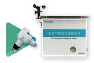
华电智控(北京)技术有限公司自主研发的恶臭气体在线监控系统,采用电子鼻和 阵列传感器技术,可对企业排放的硫化氢、氨气、挥发性有机物等恶臭气体进行在线实 时监测,可广泛应用于化工园区、污水处理厂、垃圾处理厂、制药厂的厂界监控。
